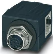
Schaltschrankdurchführung, M12, 8-polig, A-kodiert auf RJ45-Buchse, Buchseneingang 90°, IP65/67
