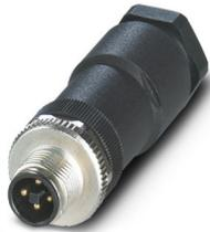
Power-Steckverbinder, Leistung, 4-polig, ungeschirmt, Stecker gerade M12, Kodierung: T, Schraubanschluss, Rändelmaterial: Zinkdruckguss, vernickelt, Kabelverschraubung Pg11, Leitungsaußendurchmesser 8 mm ... 10 mm, für Gleichstrom bis 12 A / 63 V, Kontakt 4 voreilend
