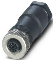
Power-Steckverbinder, Leistung, 4-polig, Buchse gerade M12, Kodierung: S, Schraubanschluss, Rändelmaterial: Zinkdruckguss, vernickelt, Kabelverschraubung Pg11, Leitungsaußendurchmesser 8 mm ... 10 mm, für Wechselstrom bis 12 A/630 V
