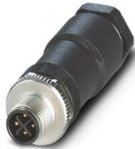
Power-Steckverbinder, Leistung, 4-polig, Stecker gerade M12, Kodierung: S, Schraubanschluss, Rändelmaterial: Zinkdruckguss, vernickelt, Kabelverschraubung Pg11, Leitungsaußendurchmesser 8 mm ... 10 mm, für Wechselstrom bis 12 A/630 V, Kontakt 4 voreilend
