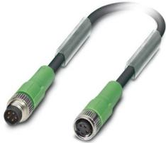
Sensor-/Aktor-Kabel, 5-polig, PUR halogenfrei, schwarzgrau RAL 7021, Stecker gerade M8, Kodierung: B, auf Buchse gerade M8, Kodierung: B, Kabellänge: 0,6 m
