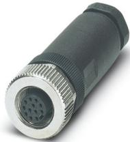
Steckverbinder, Universal, 12-polig, Buchse gerade M12, Kodierung: A, Lötanschluss, Rändelmaterial: Zinkdruckguss, vernickelt, Kabelverschraubung Pg9, Leitungsaußendurchmesser 6 mm ... 8 mm
