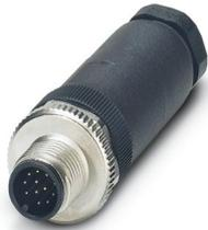
Steckverbinder, Universal, 12-polig, Stecker gerade M12, Kodierung: A, Lötanschluss, Rändelmaterial: Zinkdruckguss, vernickelt, Kabelverschraubung Pg9, Leitungsaußendurchmesser 6 mm ... 8 mm
