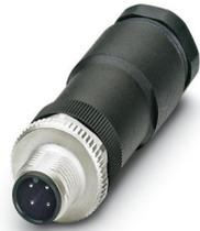
Power-Steckverbinder, 4-polig, Stecker gerade M12, Kodierung: A, Schraubanschluss, Rändelmaterial: Zinkdruckguss, vernickelt, Kabelverschraubung Pg11, Leitungsaußendurchmesser 8 mm ... 10 mm
