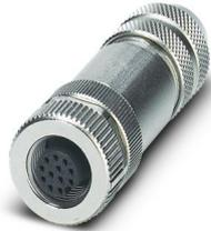
Steckverbinder, Universal, 12-polig, geschirmt, Buchse gerade M12, Kodierung: A, Lötanschluss, Rändelmaterial: Zinkdruckguss, vernickelt, Kabelverschraubung Pg9, Leitungsaußendurchmesser 6 mm ... 8 mm
