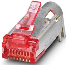
Stifteinsatz RJ45, CAT6, 8-polig, geschirmt, IDC-Pierceanschluss, für Litzen AWG 27 ... 24, mit Zugentlastung
