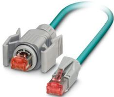
Konfektioniertes Ethernet-Kabel, CAT5e, geschirmt, 2-paarig, AWG 26 flexibel (7-drähtig), RAL 5021 (wasserblau), RJ45-Stecker/IP67, grau auf RJ45-Stecker/IP20, Line, Länge 1,5 m
