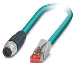
Konfektioniertes Ethernet-Kabel, geschirmt, 4-paarig, AWG 26 flexibel (7-drähtig), RAL 5021 (wasserblau), M12-Stecker auf RJ45-Stecker/IP20, Line, Länge 10 m
