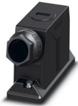
Tüllengehäuse B24, mit Schraubverriegelung, Material: PA, Kabelabgänge: 1, seitlich, M40, Höhe: 95 mm, Kabelverschraubung: mit, Standard
