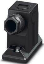
Tüllengehäuse B10, mit Schraubverriegelung, Material: PA, Kabelabgänge: 1, seitlich, M32, Höhe: 95 mm, Kabelverschraubung: mit, Standard
