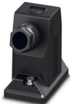
Tüllengehäuse B6, mit Schraubverriegelung, Material: PA, Kabelabgänge: 1, seitlich, M20, Höhe: 93,7 mm, Kabelverschraubung: mit, Standard
