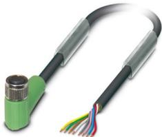
Sensor-/Aktor-Kabel, 8-polig, PUR halogenfrei, schwarzgrau RAL 7021, freies Leitungsende, auf Buchse gewinkelt M8, Kodierung: A, Kabellänge: 3 m
