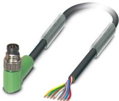
Sensor-/Aktor-Kabel, 8-polig, PUR halogenfrei, schwarzgrau RAL 7021, Stecker gewinkelt M8, Kodierung: A, auf freies Leitungsende, Kabellänge: 1,5 m
