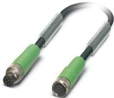
Sensor-/Aktor-Kabel, 8-polig, PUR halogenfrei, schwarzgrau RAL 7021, geschirmt, Stecker gerade M8, Kodierung: A, auf Buchse gerade M8, Kodierung: A, Kabellänge: 0,6 m
