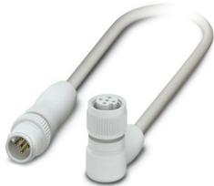
Sensor-/Aktor-Kabel, 5-polig, PP-EPDM halogenfrei, grau RAL 7035, Stecker gerade M12, Kodierung: A, mit 3 LEDs, auf Buchse gewinkelt M12, Kodierung: A, mit 3 LEDs, Kabellänge: 3 m, Hygienic Design, mit Kunststoffrändel
