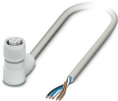
Sensor-/Aktor-Kabel, 5-polig, PP-EPDM halogenfrei, grau RAL 7035, freies Leitungsende, auf Buchse gewinkelt M12, Kodierung: A, Kabellänge: 3 m, Hygienic Design, mit Kunststofffrüdel
