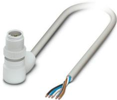
Sensor-/Aktor-Kabel, 5-polig, PP-EPDM halogenfrei, grau RAL 7035, Stecker gewinkelt M12, Kodierung: A, auf freies Leitungsende, Kabellänge: 10 m, Hygienic Design, mit Kunststoffrändel
