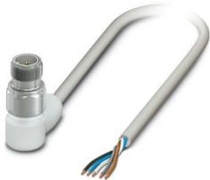
Sensor-/Aktor-Kabel, 5-polig, PP-EPDM halogenfrei, grau RAL 7035, Stecker gewinkelt M12, Kodierung: A, auf freies Leitungsende, Kabellänge: 5 m, Hygienic Design, mit Edelstahlrändel
