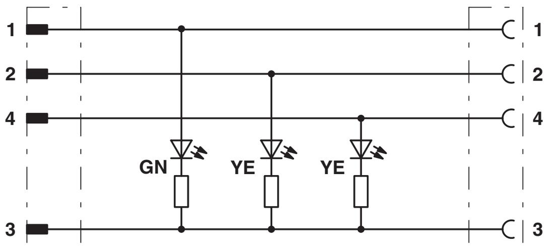
Kontaktbelegung des M12-Stecker und der M12-Buchse
