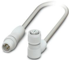
Sensor-/Aktor-Kabel, 4-polig, PP-EPDM, grau RAL 7035, Stecker gerade M12, Kodierung: A, mit 3 LEDs, auf Buchse gewinkelt M12, Kodierung: A, mit 3 LEDs, Kabellänge: 3 m, Hygienic Design, mit Kunststoffrändel
