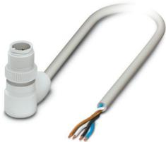
Sensor-/Aktor-Kabel, 4-polig, PP-EPDM, grau RAL 7035, Stecker gewinkelt M12, Kodierung: A, auf freies Leitungsende, Kabellänge: 3 m, Hygienic Design, mit Kunststofffrädel
