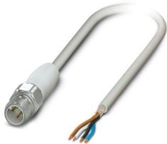
Sensor-/Aktor-Kabel, 4-polig, PP-EPDM halogenfrei, grau RAL 7035, geschirmt, Stecker gerade M12, Kodierung: A, auf freies Leitungsende, Kabellänge: 5 m, Hygienic Design, mit Edelstahlrändel
