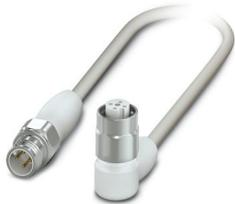
Sensor-/Aktor-Kabel, 4-polig, PP-EPDM, grau RAL 7035, Stecker gerade M12, Kodierung: A, mit 3 LEDs, auf Buchse gewinkelt M12, Kodierung: A, mit 3 LEDs, Kabellänge: 3 m, Hygienic Design, mit Edelstahlrändel
