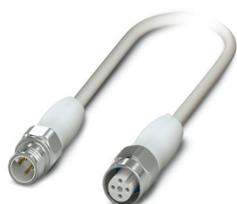
Sensor-/Aktor-Kabel, 4-polig, PP-EPDM, grau RAL 7035, Stecker gerade M12, Kodierung: A, auf Buchse gerade M12, Kodierung: A, Kabellänge: 0,3 m, Hygienic Design, mit Edelstahlrändel
