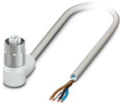
Sensor-/Aktor-Kabel, 4-polig, PP-EPDM, grau RAL 7035, freies Leitungsende, auf Buchse gewinkelt M12, Kodierung: A, mit 3 LEDs, Kabellänge: 3 m, Hygienic Design, mit Edelstahlrändel
