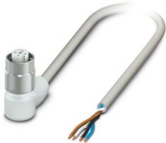
Sensor-/Aktor-Kabel, 4-polig, PP-EPDM, grau RAL 7035, freies Leitungsende, auf Buchse gewinkelt M12, Kodierung: A, Kabellänge: 10 m, Hygienic Design, mit Edelstahlrändel
