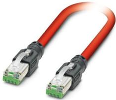
Sercos III-Patch-Kabel, geschirmt, Sternvierer, AWG 22 flexibel (7-drähtig), RAL 3020 (verkehrsrot), RJ45-Stecker/IP20, gerade, auf RJ45-Stecker/IP20, gerade, Länge: 10 m
