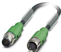
Sensor-/Aktor-Kabel, 8-polig, PUR halogenfrei, schwarzgrau RAL 7021, geschirmt, Stecker gerade M12 SPEEDCON, Kodierung: A, auf Stecker gerade M12 SPEEDCON, Kabellänge: 3,5 m
