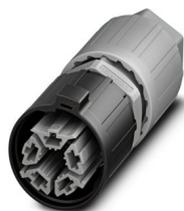
Steckverbinder, Anschlussart: IDC-Anschluss, Polzahl: 4+PE, 1 mm<sup>2</sup> ... 2,5 mm<sup>2</sup>, 690 V, 20 A, PA, grau, Leitungsaußendurchmesser: 6 mm ... 11 mm
