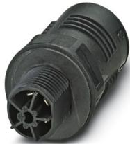
Wanddurchführung, Anschlussart: Flachsteckanschluss (für Flachsteckhülsen nach DIN 46247-2), Polzahl: 4+PE, M20, Stift, 1 mm<sup>2</sup> ... 2,5 mm<sup>2</sup>, 690 V, 20 A, PA, schwarz, ohne QUICKON-Mutter, Kodierung: kodiert
