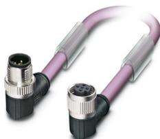
Bussystem-Kabel, PROFIBUS (12 MBit/s), 2-polig, PUR halogenfrei, violett RAL 4001, geschirmt, Stecker gewinkelt M12 SPEEDCON, Kodierung: B, auf Buchse gewinkelt M12 SPEEDCON, Kodierung: B, Kabellänge: 0,3 m
