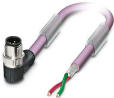
Bussystem-Kabel, PROFIBUS (12 MBit/s), 2-polig, PUR halogenfrei, violett RAL 4001, geschirmt, Stecker gerade M12 SPEEDCON, Kodierung: B, auf freies Leitungsende, Kabellänge: 5 m
