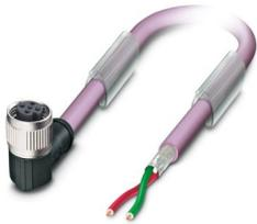
Bussystem-Kabel, PROFIBUS (12 MBit/s), 2-polig, PUR halogenfrei, violett RAL 4001, geschirmt, freies Leitungsende, auf Buchse gewinkelt M12 SPEEDCON, Kodierung: B, Kabellänge: 2 m
