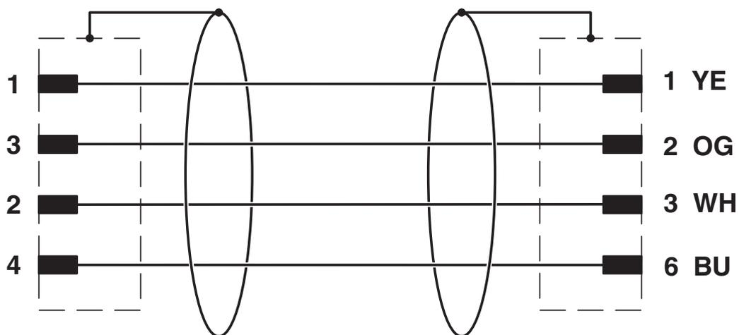
Kontaktbelegung des M12- und RJ45-Steckers
