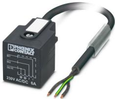
Sensor-/Aktor-Kabel, 3-polig, PUR halogenfrei, schwarzgrau RAL 7021, freies Leitungsende, auf Ventilstecker A, Beschaltung: unbeschaltet, Kabellänge: 1,5 m
