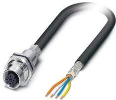
Gerätesteckverbinder Hinterwand, PROFINET CAT5 (100 MBit/s) CAT5 (100 MBit/s), 4-polig, PE-X halogenfrei, grün RAL 6018, geschirmt, Buchse, gerade, M12-SPEEDCON, D-Kodierung, auf freies Leitungsende, Kabelanschluss, Kabellänge: 2 m, 0,34 mm<sup>2</sup>, PROFINET, dieser Artikel ist voraussichtlich ab 2027-Q1 nach RoHS II ohne Ausnahme 6c (Pb < 0,1 %) bleifrei, auf Anfrage ist eine bleifreie Alternative vorab möglich
