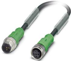
Sensor-/Aktor-Kabel, 3-polig, PUR halogenfrei, schwarzgrau RAL 7021, Stecker gerade M12, Kodierung: A, auf Buchse gerade M12, Kodierung: A, Kabellänge: 5 m, für Ventilstecker
