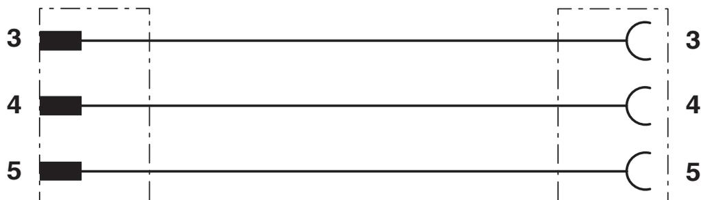
Kontaktbelegung des M12-Steckers und der M12-Buchse
