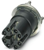
Kontaktträger, Ethernet CAT6<sub>A</sub>, 8-polig, Buchse, gerade, M12, X-Kodierung, THR-Lötanschluss, dieser Artikel ist voraussichtlich ab 2025-Q4 nach RoHS II ohne Ausnahme 6c (Pb < 0,1 %) bleifrei, auf Anfrage ist eine bleifreie Alternative vorab möglich
