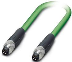
Netzwirkkabel, Ethernet (100 MBit/s), PROFINET (100 MBit/s), EtherCAT® (100 MBit/s), 4-polig, PVC/PVC, grün RAL 6018, Stecker gerade M8, Kodierung: A / IP67, auf Stecker gerade M8, Kodierung: A / IP67, Kabellänge: 0,5 m
