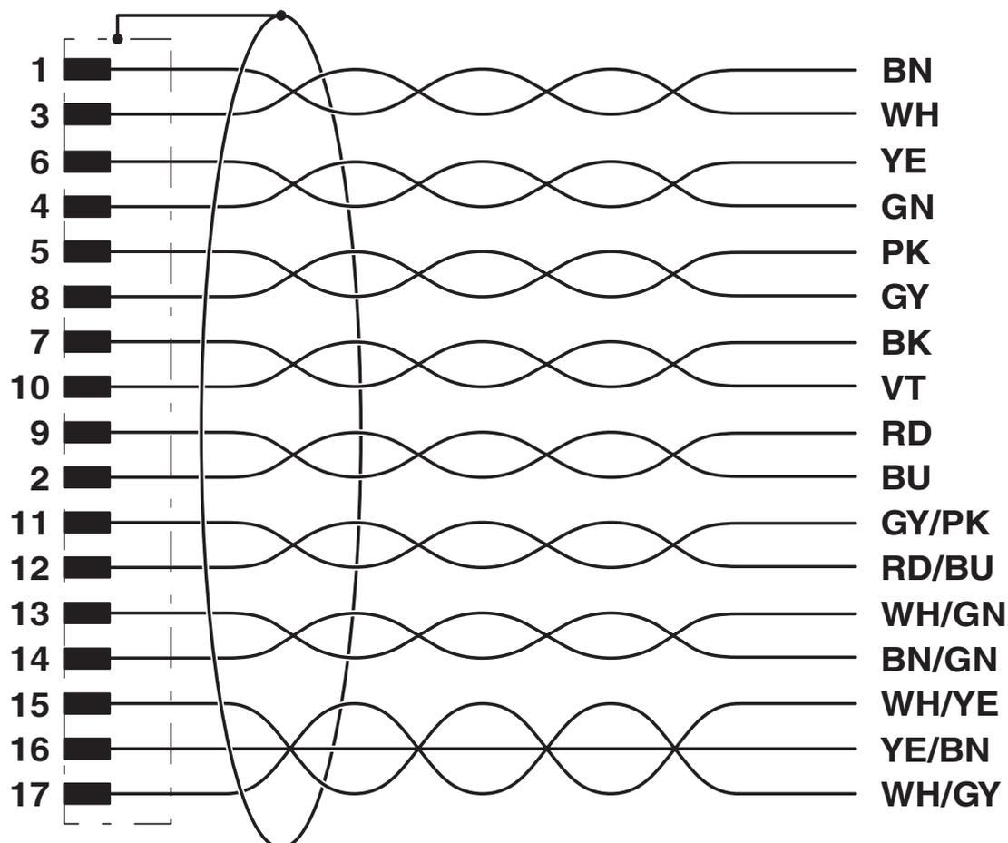
Kontaktbelegung des M12-Steckers
