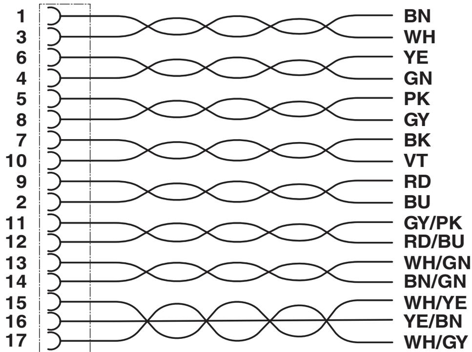
Kontaktbelegung der M12-Buchse
