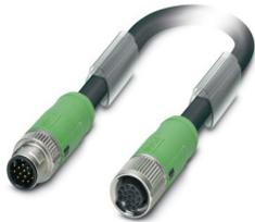
Sensor-/Aktor-Kabel, 17-polig, PUR/PVC, schwarz RAL 9005, geschirmt, Stecker gerade M12-SPEEDCON, A-kodiert, auf Buchse gerade, M12-SPEEDCON, Kabellänge: 10 m
