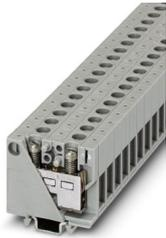
Minidurchgangsklemme, Nennspannung: 500 V, Nennstrom: 61 A, Anzahl der Anschlüsse: 2, Anschlussart: Schraubanschluss, 1. Etage, Querschnitt: 0,5 mm<sup>2</sup> - 10 mm<sup>2</sup>, Montageart: NS 15, Farbe: grau
