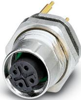
Gerätesteckverbinder Hinterwand, Universal, 4-polig, geschirmt, Buchse, gerade, M12-SPEEDCON, D-Kodierung, Wellenlöten
