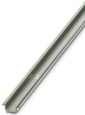
Tragschiene ungelocht, Verpackungsvariante mit 10 Stück (20 m), nach EN 60715, Material: Stahl, verzinkt, dickschichtpassiviert, Standardprofil, Farbe: silberfarben
