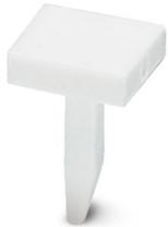
Marker für Klemmen, Nagel, weiß, unbeschriftet, beschriftbar mit: Bezeichnungsstift, Montageart: stecken, für Klemmenbreite: 4,2 mm, Anzahl der Einzelschilder: 1, Textfeldhöhe: 4 mm, Textfeldbreite: 4 mm
