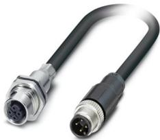
Gerätesteckverbinder Hinterwand, Kabellänge: 1,2 m, Polzahl: 4, 100 MBit/s, CAT5, Anschlussart: Kabelanschluss, PROFINET, 1x4xAWG22/7, SF/TQ, schwarz RAL 9005
