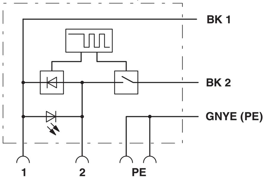
Kontaktbelegung des Ventilsteckers
