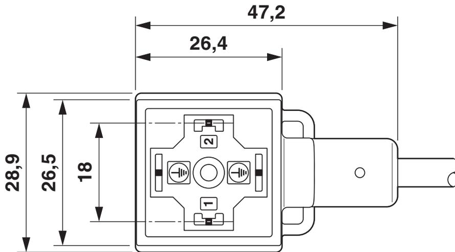
Ventilstecker, Bauform A
