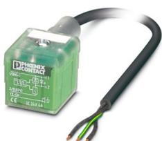
Sensor-/Aktor-Kabel, 3-polig, PUR halogenfrei, schwarzgrau RAL 7021, freies Leitungsende, auf Ventilstecker A, mit 1 LED, Beschaltung: Freilaufdiode mit Haltestrombegrenzer, Kabellänge: 3 m, mit Haltestrombegrenzer zur Energiereduzierung
