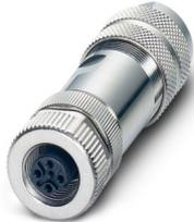
Datensteckverbinder, PROFIBUS, INTERBUS, 5-polig, geschirmt, Buchse gerade M12, Kodierung: B, Schraubanschluss, Rändelmaterial: Zinkdruckguss, vernickelt, Kabelverschraubung Pg11, Leitungsaußendurchmesser 8 mm ... 10 mm
